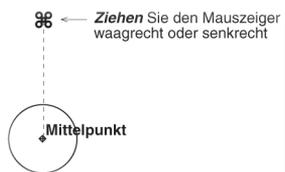
Wenn Sie jetzt den Mauszeiger über einen Punkt bewegen (die Anmerkung **Endpunkt**, **Seitenmitte** etc. des *Fangassistenten* muss eingeblendet sein) und dann den Mauszeiger *waagrecht* oder *senkrecht* über den Bildschirm ziehen, wird eine gepunktete Hilfslinie durch den eingeblendeten Punkt gelegt.
