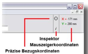
Dieses Werkzeug erlaubt die schnelle Eingabe präziser Daten für die Erstellung oder Bearbeitung von Geometrieobjekten. Es können absolute **XYZ**-Koordinaten, relative Koordinaten sowie der Abstand oder ein Prozentwert entlang eines Objekts eingegeben werden. Mit diesem Werkzeug wird es einfach, Objekte relativ zu spezifischen Koordinaten zu erstellen oder Objekte an spezifische Positionen zu verschieben.
