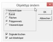
In diesem Dialogfenster können Sie Volumenkörper in eine Anzahl von Kurven, in Flächen oder Polygonnetze umwandeln. Falls Sie Volumenkörper in Facettennetzflächen umwandeln, wird folgende Dialogfenster eingeblendet:
